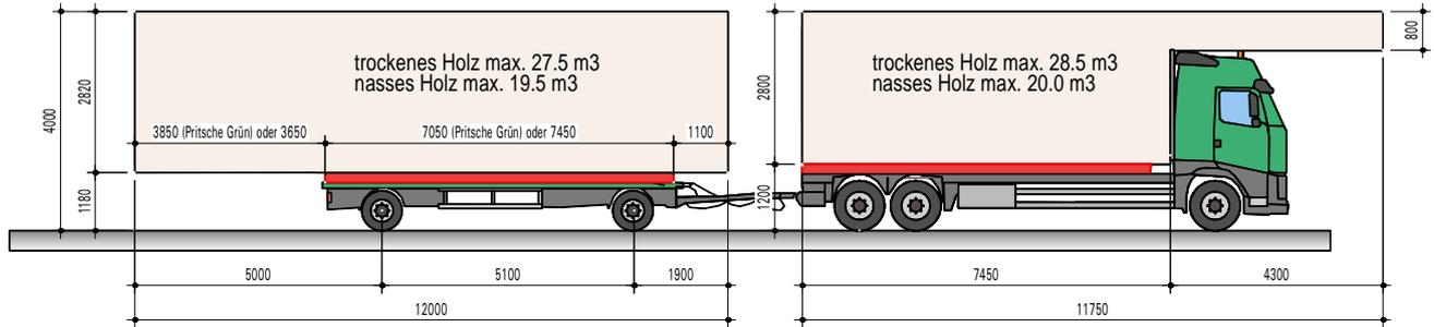
Über gesamter Zug maximal trockenes Holz max. 50 m<sup>3</sup>
