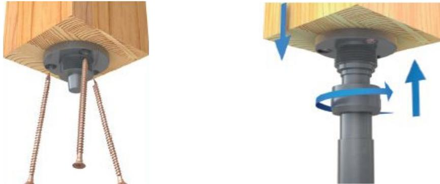
Die Kopfplatte wird stirnseitig zentriert und mit drei SHERPA Spezialschrauben in einem Winkel von ca. 25 ° befestigt. Mit dem Konus wird die Kopfplatte passgenau auf den Unterbau gesetzt. Die Verbindung der beiden Teile erfolgt mit der Überwurfmutter als Schraubverschluss.
