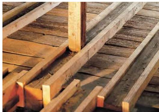
Bei **KERTO S/T (Stab)** verlaufen die Fasern der Furnierlagen ausschliesslich in der Plattenlängsrichtung. Es wird als Platte produziert und in Streifen aufgetrennt, die als Balken in verschiedensten Konstruktionen für hochbeanspruchte, stabförmige Bauteile (Balken, Binder, Pfetten, Stützen) eingesetzt werden können.
